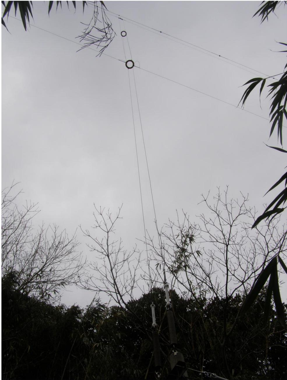
一度上下エレメントの中間位置まで平衡給電線を立ち上げ、その後上下に等距離給電
